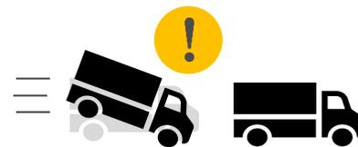
急激な発進・加速、減速・停止をGセンサ(前後)で検知
