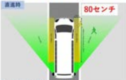
直進時には危険ゾーンが狭く設定、速度に反応しない設計。（法で定められた安全距離）
